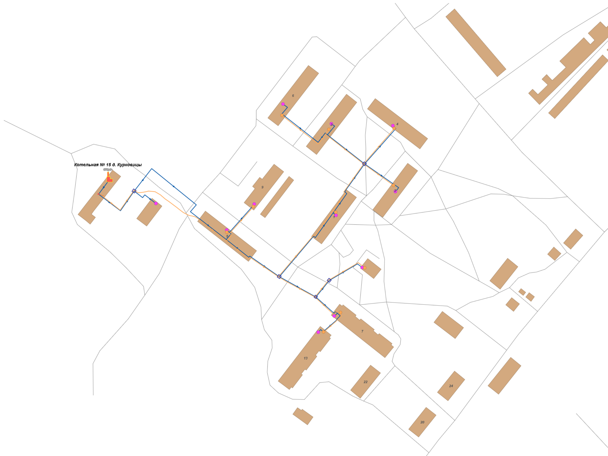
Рисунок 5. Схема расположения тепловых сетей от котельной № 15, д. Курковицы филиала «ВКС» АО «Тепловые сети» Калитинского сельского поселения
