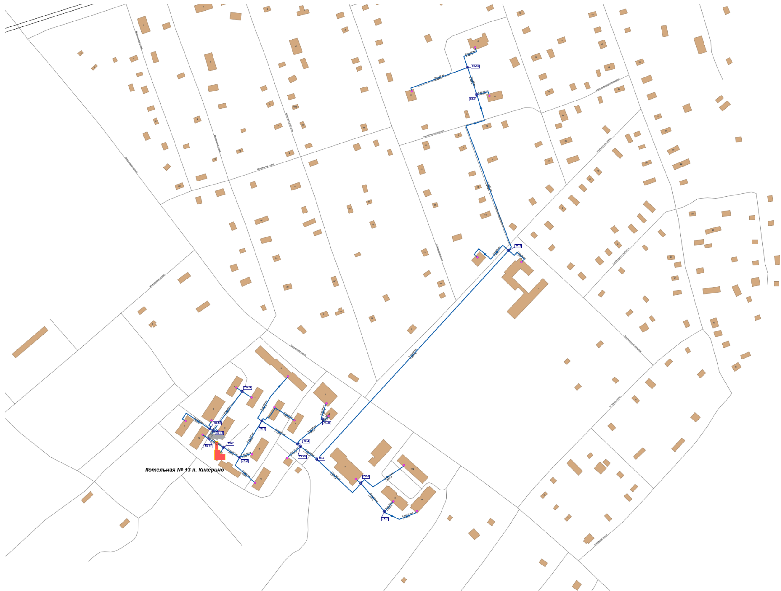
Рисунок 4. Схема расположения тепловых сетей от котельной № 13, п. Кикерино филиала «ВКС» АО «Тепловые сети» Калитинского сельского поселения
