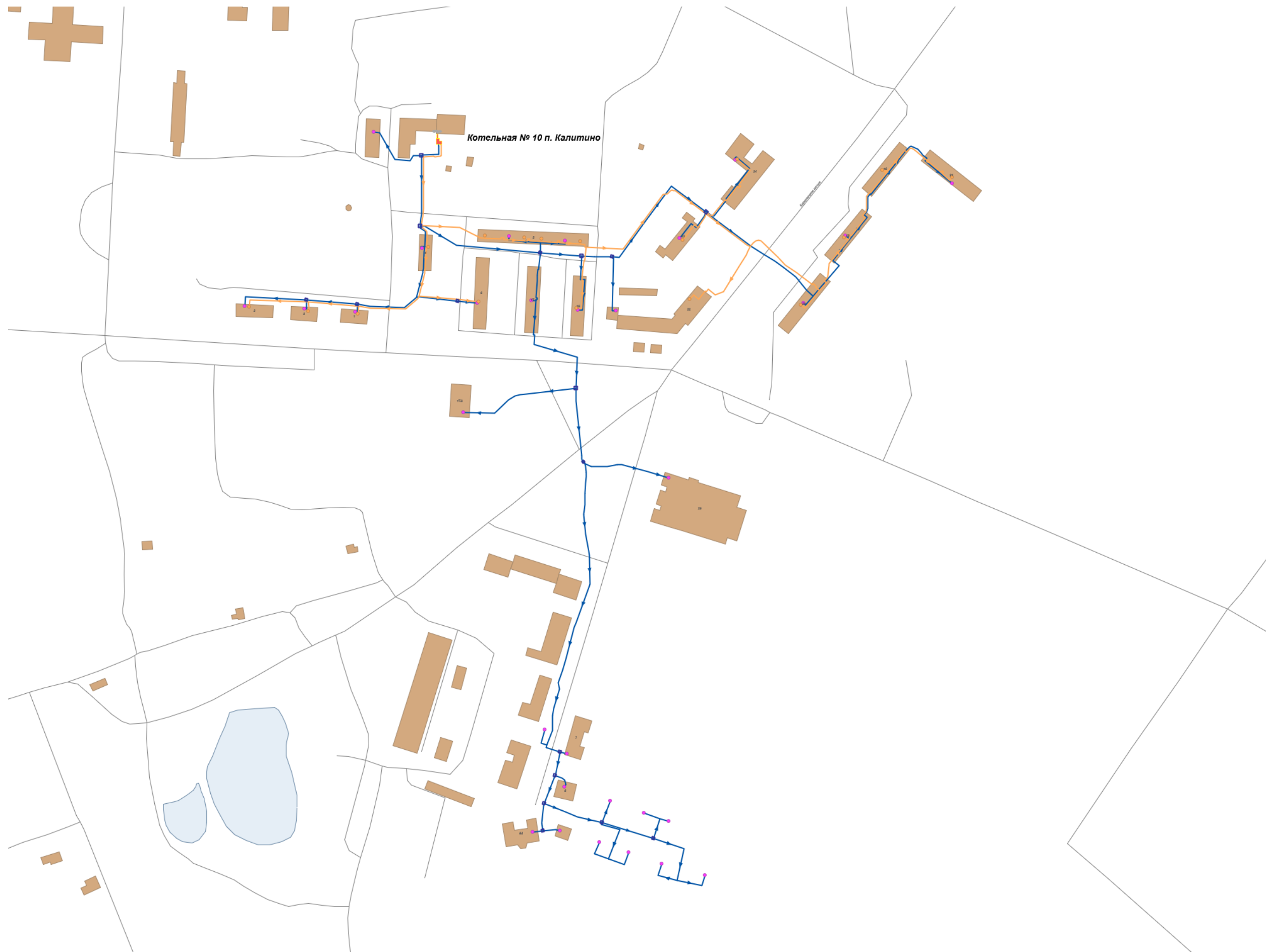
Рисунок 3. Схема расположения тепловых сетей от котельной № 10 п. Калитино филиала «ВКС» АО «Тепловые сети» Калитинского сельского поселения
