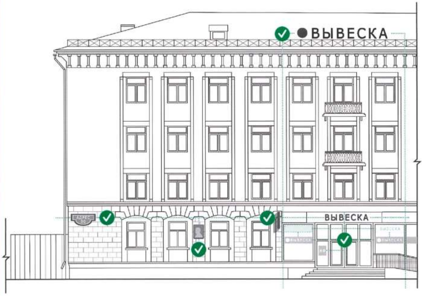
Рисунок 2. Рекомендуемые варианты размещения информационных конструкций различных видов на фасаде здания, строения, сооружения и ограждения.
